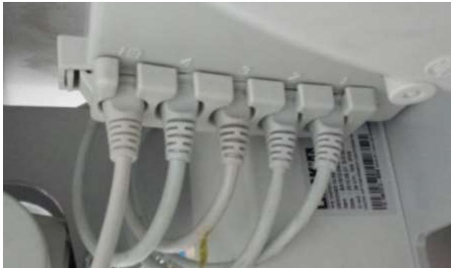
Sur le boîtier CB06, déclipser la barrette anti-arrachement sur le côté gauche uniquement. Il suffit de glisser un tournevis entre l'extérieur et le clip de la barrette puis de pousser vers l'intérieur comme expliqué ci-dessous.
