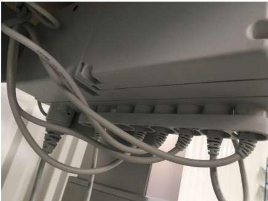
Sur le boîtier CB16, pour déclipser la barrette anti-arrachement, munissez-vous d'un tournevis plat.
