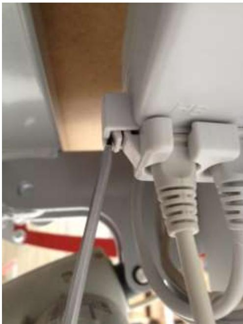
Débrancher le connecteur de la télécommande du boîtier CB06 (emplacement HB sur la photo).
