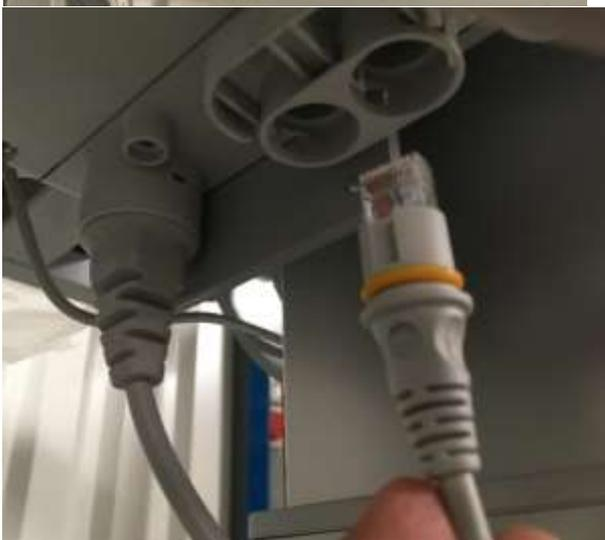
Débrancher la prise de la télécommande et remplacer par la nouvelle. Attention à respecter le sens il y a une encoche à placer vers vous comme ci-dessus.
