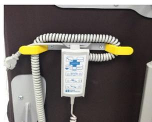
Dispositif optionnel permettant le rangement du câble d'alimentation et de la télécommande en option sur toutes les versions.
