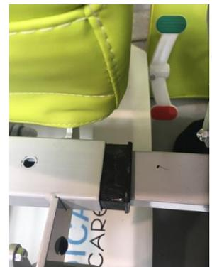
Insérer le complètement à l'aide d'un maillet en tapant de chaque côté, de façon à ce que le manchon soit en contact contre l'assise.
