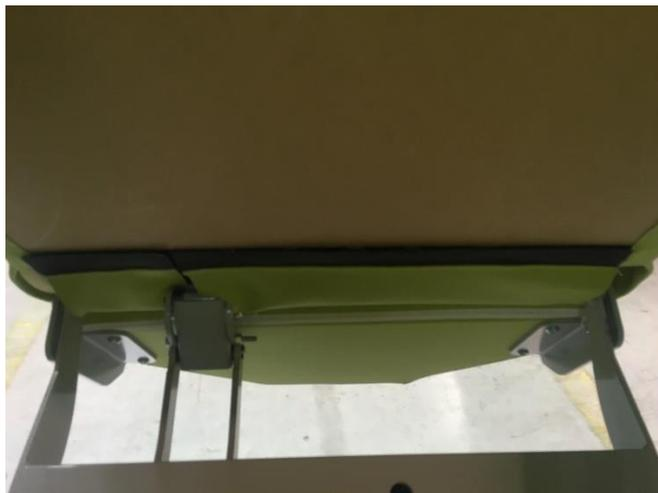
Puis repositionner l'assise de façon à ce que les têtes de vis de la traverse se logent dans les encoches de la garniture.
