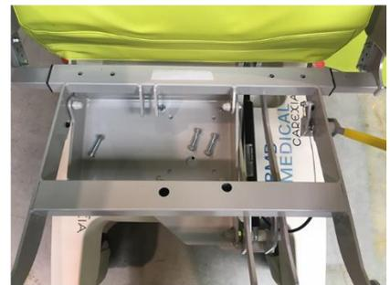
Ensuite, il faut se placer sur le côté d'un accoudoir et le soulever légèrement par l'avant et tirer sur l'accoudoir en partie basse.
