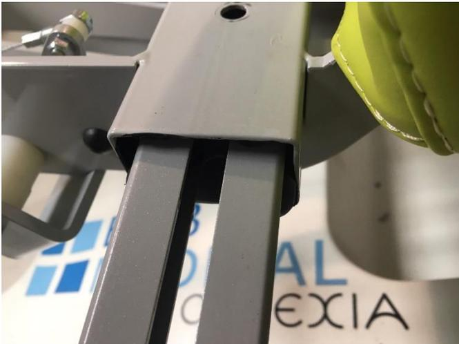
Ensuite, il faut positionner le manchon dans le tube. Pour faciliter, soulever l'accoudoir pendant le positionnement du manchon.
