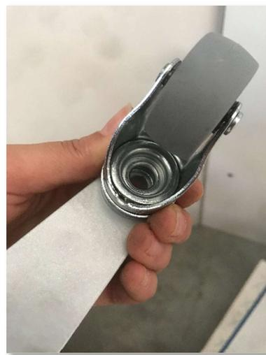
Puis munit de tournevis plat, bloquer l'écrou à frapper, puis visser la vis FHC M6x10 avec la clé Allen.
