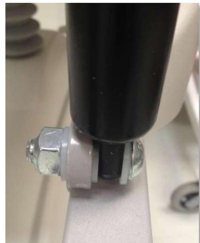
Dévisser la vis et l'écrou de fixation du vérin de façon à ce que le vérin se positionne verticalement par son propre poids.
