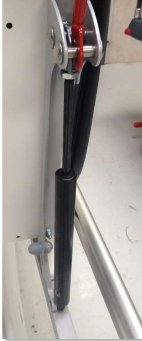
Désormais vous pouvez visser le vérin dans la tête de déclenchement jusqu'à ce que la pin de déclenchement soit en contact (ou  $< 1$  mm) de la tringle de relève buste. Vous pouvez effectuer que des demi-tours (La partie basse du vérin doit être dans l'axe du trou de fixation). ATTENTION, si la pin est trop en appui sur la tringle, le vérin se déclenchera légèrement et le relève buste remontera tout seul.
