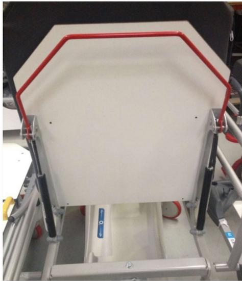
La première étape va consister à vérifier, si le réglage est correct, le positionnement du vérin dans la tête de déclenchement doit être comme ci-dessous :
