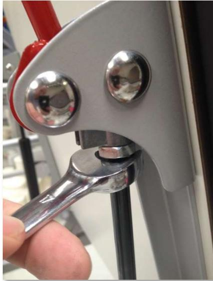
Retirer les 2 bouchons en partie basse du vérin à l'aide d'un cutter ou tournevis fin
