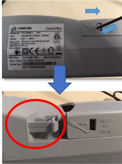
Commencer par refixer le boîtier sur la traverse à l'aide des 2 vis. Rebrancher le câble d'alimentation à l'arrière du boîtier. **ATTENTION DE BIEN RESPECTER LE PASSAGE DU CABLE NOIR DU VERIN D'ASSISE. IL DOIT PASSER AU DESSUS DU BOITIER COMME CI-DESSUS.**
