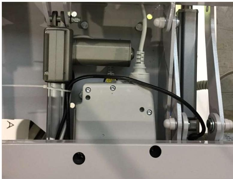
Ensuite rebrancher l'ensemble des câbles en respectant leur emplacement. Et clipser les câbles dans la barrette à gauche prévu pour cela.
