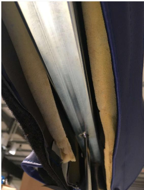
L'insérer jusqu'en bas et remettre les scratchs. Dans le cas où ils sont difficiles d'accès remonter l'assise et passer par devant pour bien scratcher en partie basse.
