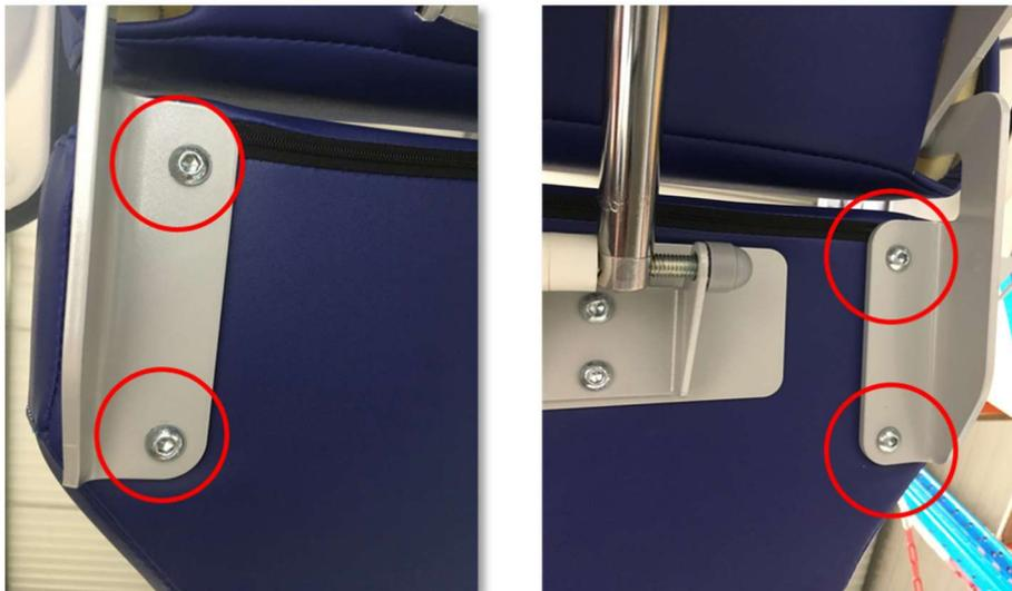
Ensuite sur la nouvelle garniture, il y a déjà les 4 inserts pour la fixation des articulations relève jambe. Par contre les 2 inserts de la fixation du vérin ne sont pas visibles mais présentes. Pour cela, au toucher, repérer l'emplacement des 2 trous puis percer au tournevis.
