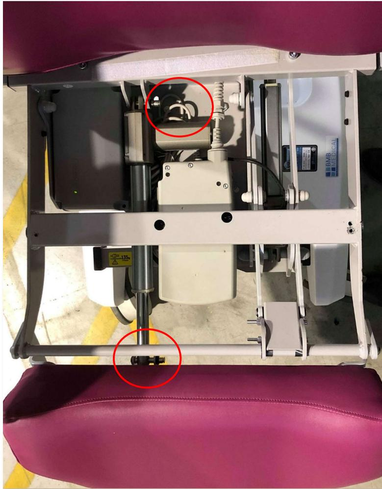
Retirer ces axes afin de pouvoir enlever le vérin, pour cela à l'aide d'un tournevis plat retirer les clips noirs, puis faire glisser les axes comme indiqué sur les photos. (Pas besoin de les retirer complètement)
