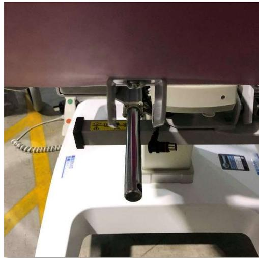
Une fois que tout est en place, procédez à la fixation du vérin. Placer les axes puis repositionner les clips.
