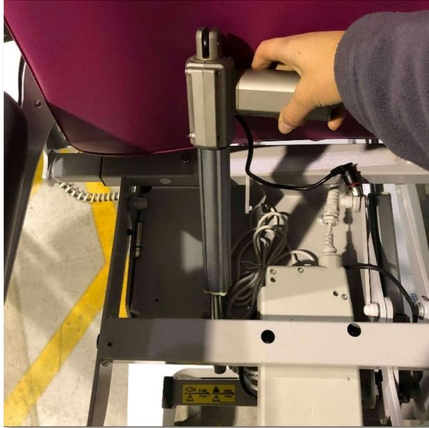
Positionner le vérin face aux pattes de fixation, en faisant attention au câble de branchement.
