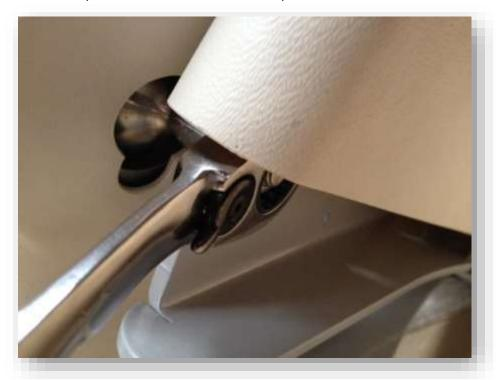
Puis retirer l'accoudoir du bras. Poser le sur un support adapté pour ne pas abîmer le repose bras de l'accoudoir. Il sera réinstallé par la suite sur le nouveau bras inférieur.
