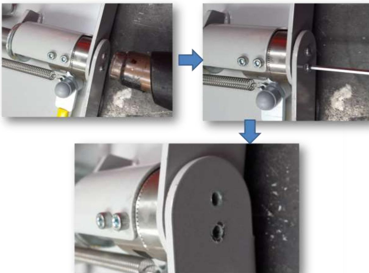
Séparez les deux parties l'une de l'autre. Il est inutile de démonter les deux commandes (avec embouts jaune).
