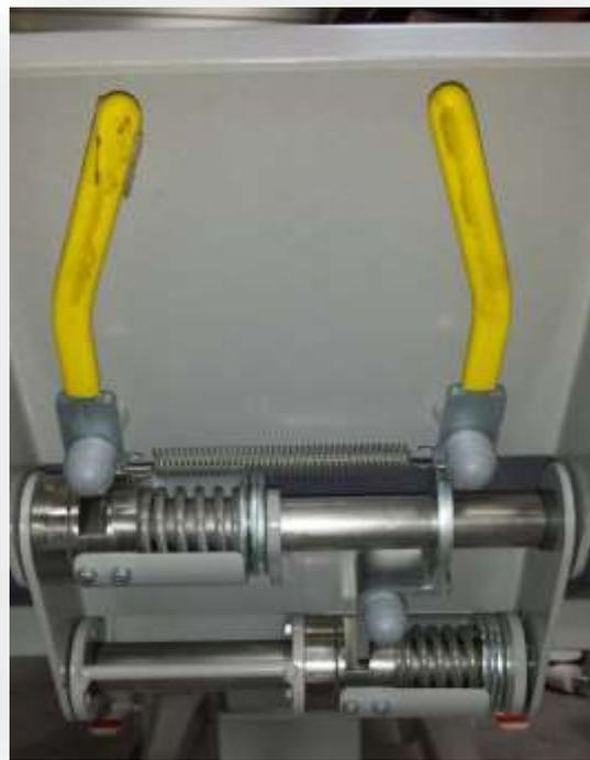
Prendre la décapeuse thermique, placer la à 3 cm des vis de la partie basse de la tête. Chauffer les vis pendant 30s environ (attention de ne pas dégrader les paliers). Ainsi, il sera plus facile de les dévisser.
