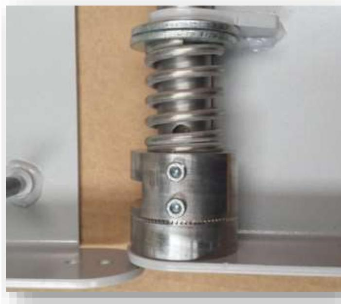
Repositionner la partie haute de la tête sur la partie basse. Aligner les trous de l'axe central avec ceux de la tôle.
