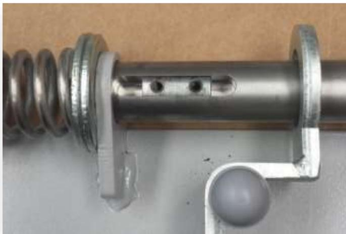
Aligner les trous du crabot avec les trous de la clavette, puis y visser les vis sans serrer sinon le crabot ne pourra pas se déplacer. Ne pas remettre la plaque arrondie.
