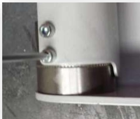
Désormais, il est possible de sortir l'axe central. Pour cela, prendre un maillet et un axe d'un diamètre proche de celui de l'axe central et frapper du côté où il y a les crabots. Lorsque l'axe central est comme ci-dessous vous pouvez enlever les 3 rondelles et le ressort (faire attention).
