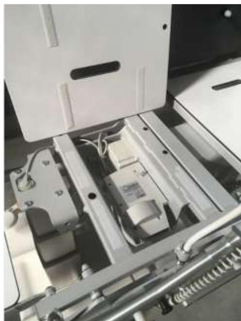
Dans le cas où vous possédez un plan dur collé ou d'un matelas fixe, accéder à l'aide d'une clé à plate à l'écrou au centre du boîtier en la passant entre le matelas et le boîtier.
