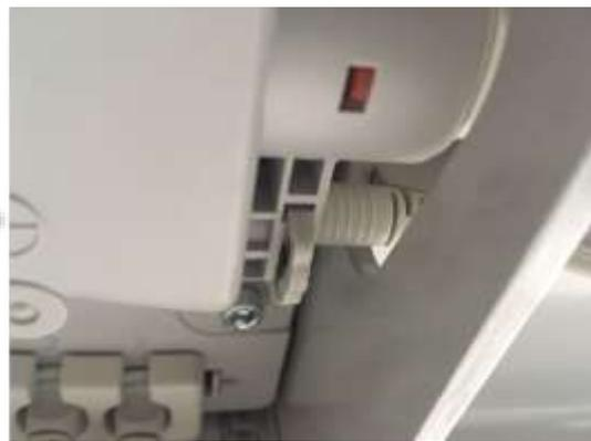
Sur le boîtier CB06, déclipser la barrette anti-arrachement sur le côté gauche et droit (utiliser un petit tournevis). Il suffit de glisser le tournevis entre l'extérieur et le clip de la barrette puis de pousser vers l'intérieur comme expliqué ci-dessous.
