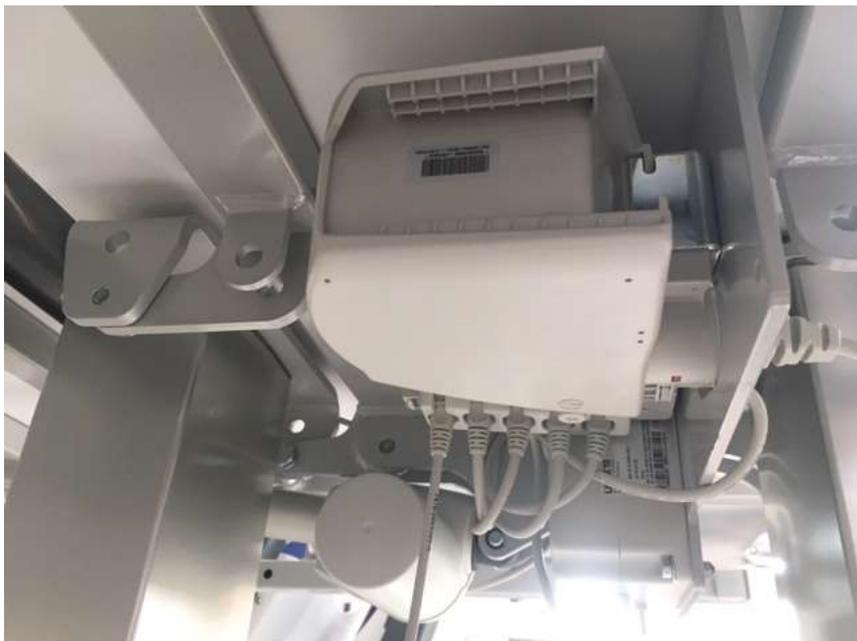
Ensuite, débrancher le câble d'alimentation placé à l'arrière du boîtier.
