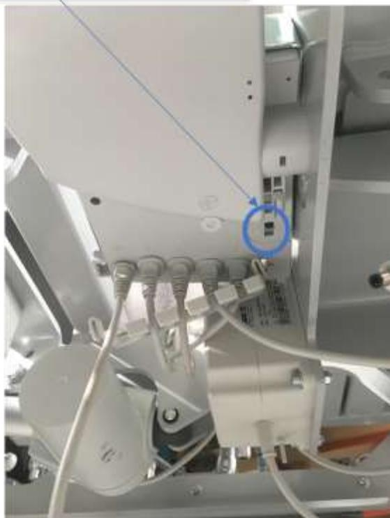
Pour le désolidariser de son support effectuer une rotation dans le sens inverse des aiguilles d'une
