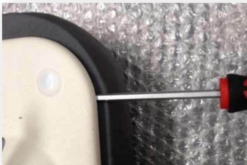
Lorsque vous êtes à l'étape ci-dessous, dévisser les 2 vis qui maintiennent l'accoudoir à la plaque en décalant le capot. Les vis sont accessibles sans retirer le capot. Si vous souhaitez, retirer complètement le capot, vous devez dévisser les deux vis de la palette de commande.
