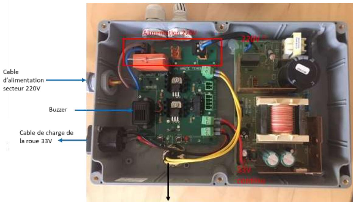
Shunt (permet de s'assurer que le câble de charge de la roue est bien rebranché sur le boîtier)
