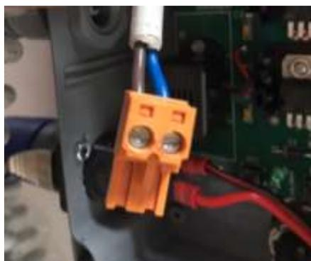
Il ne reste plus qu'à brancher le connecteur à son emplacement « LINAK\_Box\_out1 »
