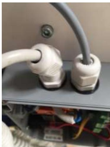
Refermer le boîtier et brancher le câble secteur du boîtier EZWHEEL. Vérifier que la led verte est bien présente sur le boîtier Linak.
