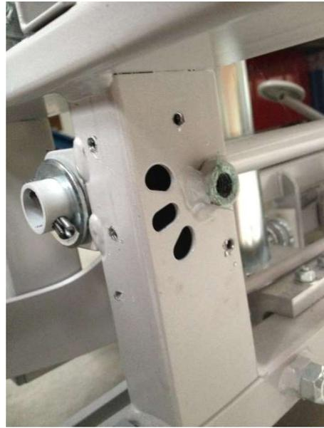
Sur la pédale, retirer le contre-écrou, puis retirer le poussoir ressort à l'aide d'une pince étau si nécessaire.
