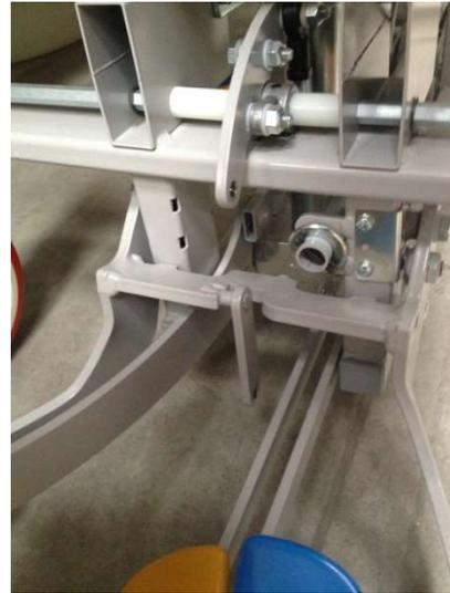
Dévisser à l'aide d'une clé plate de 16, les 2 vis latérales qui permettent de maintenir la pédale.
