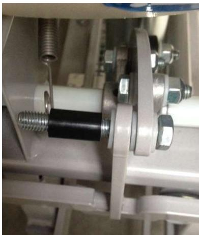
Positionner la roue en 5<sup>e</sup> roue pour faciliter le montage du ressort. Mettre le ressort dans la traverse et l'autre sur la vis puis mettre l'écrou.
