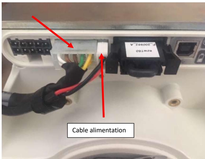
Débrancher les 2 connecteurs en appuyant sur l'anti-arrachement.
