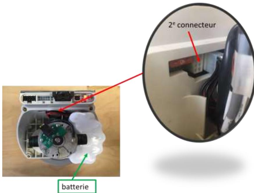
Prendre la nouvelle batterie, et brancher la sur le connecteur. ATTENTION : il faut respecter le sens du connecteur, le détrompeur vous empêchera de la monter dans le sens inverse.
