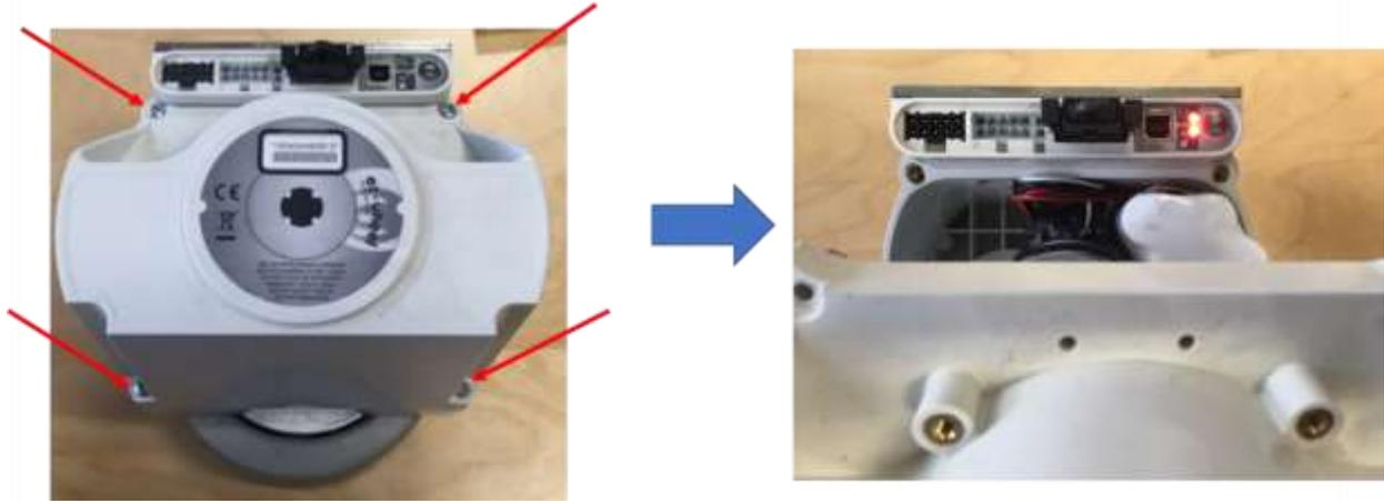
Dévisser les 4 vis à l'aide d'une clé TORX ou d'une visseuse avec un embout Torx. Puis retirer le capot pour accéder au moteur et à la batterie. Ensuite repérer le 2<sup>e</sup> connecteur batterie. Si les fils du premier connecteur vous gênent, placé les dans l'emplacement en dessous comme sur la photo ci-dessous.
