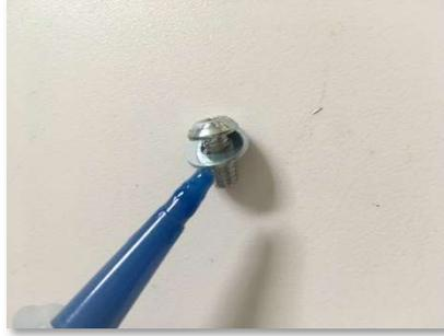
Positionner le support face aux trous prévus pour le support accessoire sur le châssis, puis visser vos 2 vis agrémenter de frein filet avec les rondelles en maintenant l'arceau.
