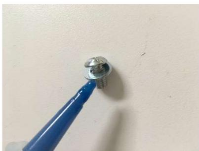
Positionner le support face aux trous prévus pour le support accessoire sur le châssis, puis visser vos 2 vis agrémenter de frein filet avec les rondelles en maintenant la tige à sérum.
