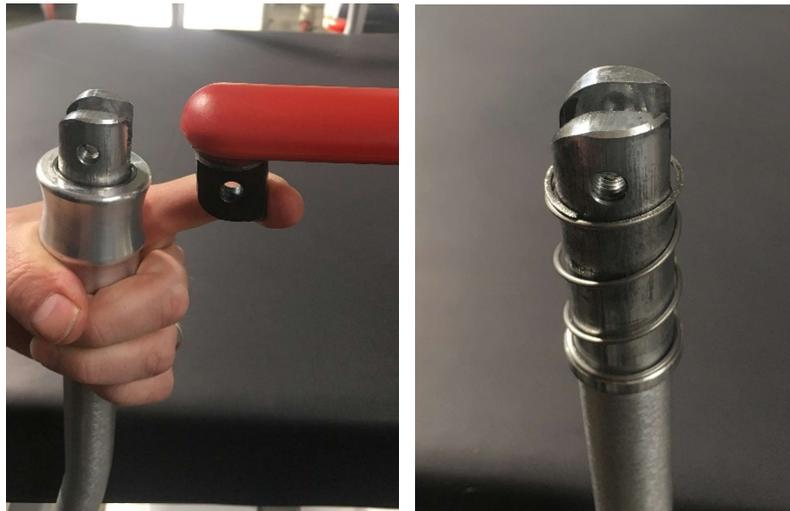
Retirer la bague et le ressort du barreau.
