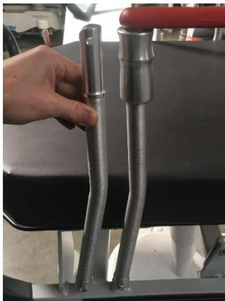
Dans le cas ci-dessus, c'est un barreau droit. Pour les identifier, sur la partie basse du barreau, il y a un méplat pour la tête de vis donc il doit être à l'extérieur.
