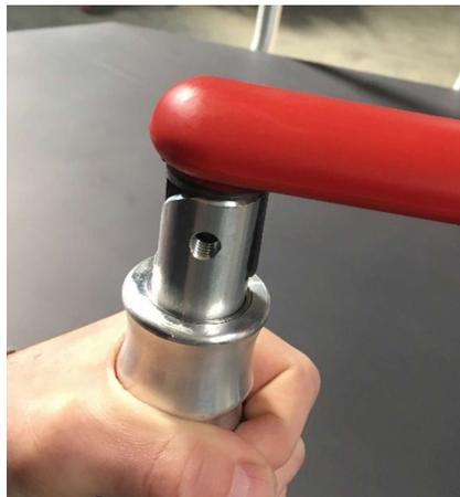
Déposer du frein filet dort sur la vis sans tête et revisser le barreau de verrouillage. Attention de ne pas trop en mettre pour ne pas qu'il ressorte lors du serrage
