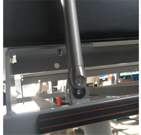
Retirer les paliers de la chappe et dégraisser la chappe inférieure pour pouvoir installer les nouveaux paliers. Dans le cas où vous ne changez pas les paliers, nettoyer les avant de les remettre.
