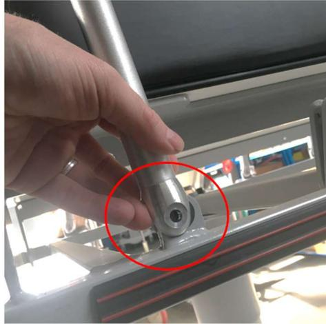
Prendre une vis neuve BHC M8\*25 en y déposant du frein filet fort. Attention de ne pas trop en mettre pour ne pas qu'il ressorte lors du serrage. Puis visser la partie basse. Inutile de serrer fort, le mouvement du barreau doit pouvoir se faire.
