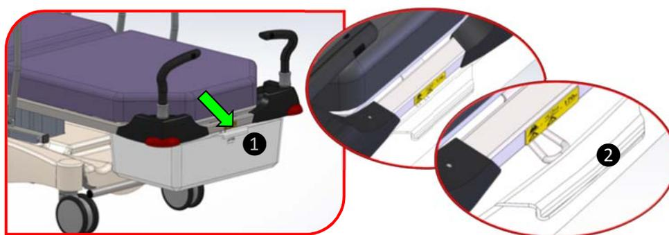
Pour verrouiller le panier à effet, le remonter jusqu'au contact du relève-buste. Vous entendrez alors un « clic ». Le verrouillage est automatique.
