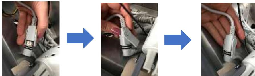
Passez le câble en dessous du vérin de hauteur variable et connectez-le au boîtier de contrôle.
