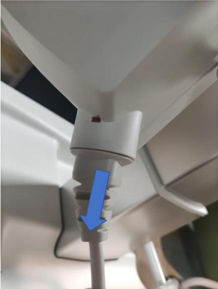
Ensuite, il faut désolidariser la batterie du boîtier. Pour cela, appuyer à l'aide d'un tournevis sur la languette et décaler la batterie.
