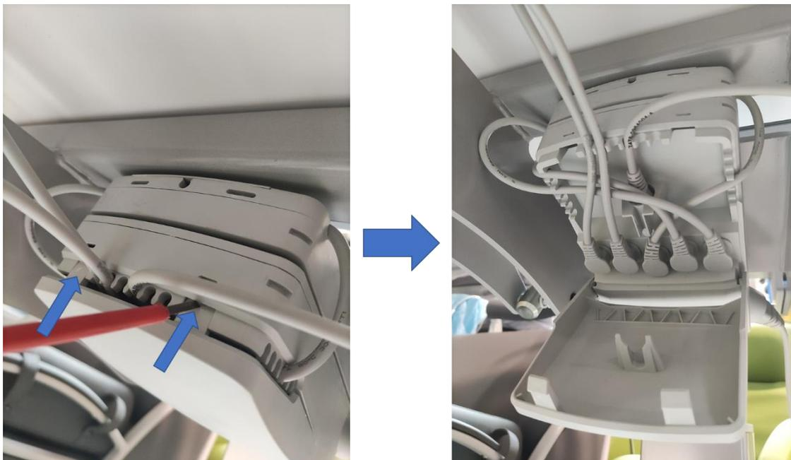
Ensuite débrancher le câble de la télécommande (connecteur sur l'avant) :
