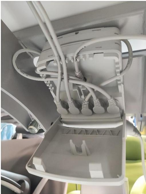
Fermer le capot. Il ne reste plus qu'à replacer l'ensemble sur le couchage.
