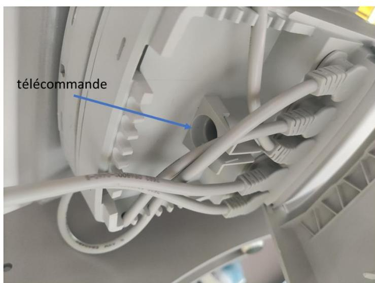
Puis le câble de la batterie (connecteur au-dessus de celui de la télécommande). Dans le cas où votre produit possède un Repose pied, ce sera le câble du répartiteur.
