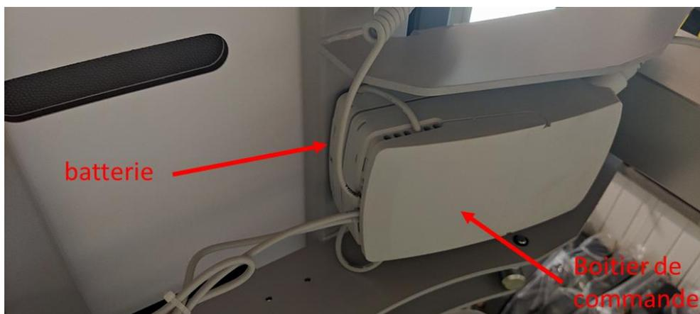
Commencer par ouvrir le capot du boîtier de commande. Pour cela, prendre un tournevis et appuyer sur les 2 languettes de chaque côté comme ci-dessous :
