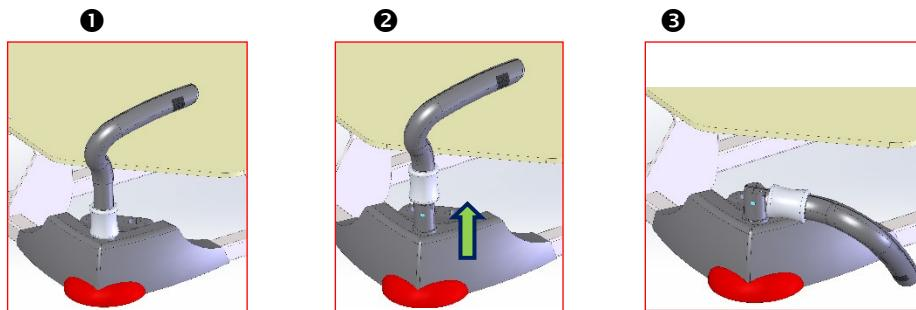
Pour les repositionner, les relever et replacer la bague en position basse. Vérifier qu'elles soient bien positionnées.
