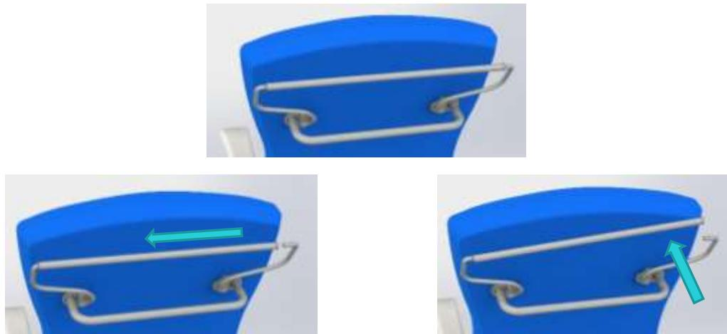
Tirer le tube vers la gauche et le soulever légèrement afin de pouvoir glisser le rouleau papier, puis tirer à nouveau le tube vers la gauche afin de le repositionner dans son logement.
