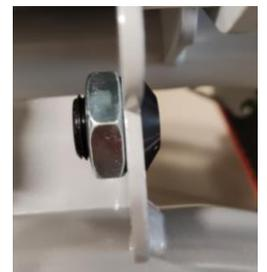
Serrage \* : revisser de façon à ce que les éléments ne puissent pas entrer en mouvement / serrage à couple élevé
